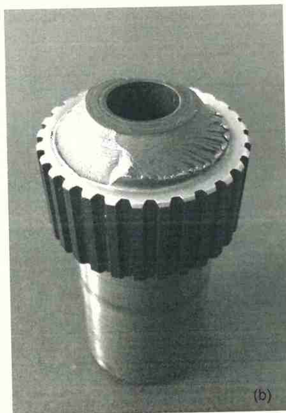
Figura 17 – Macrofotografia da superfície fraturada – observa-se a presença de ranhuras e a proximidade da fratura com a região de mudança de geometria do eixo (região concentradora de tensão). A seta em (a) indica a região observada em (b).
