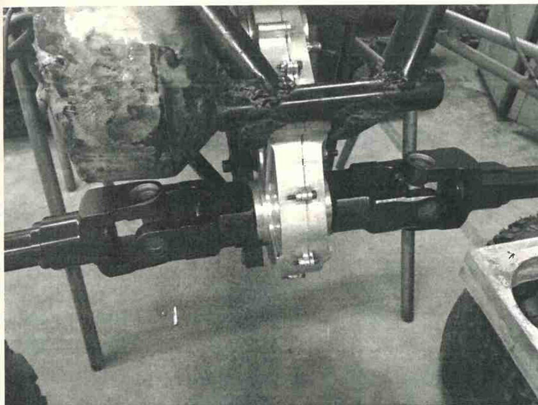
Figura 7 - Montagem do sistema de transmissão do Baja, com destaque para a caixa de redução – semelhante à estudada – ligada a dois semi eixos dotados de cruzeta.
