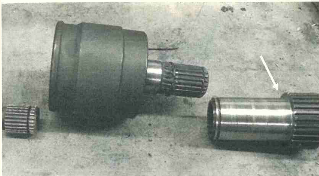
Figura 11 – Sequência de montagem das peças que compõem a transmissão. O eixo de saída da caixa de redução (à direita) conecta-se à junta homocinética (centro). A terceira peça, da direita para a esquerda, é a ponta do semieixo – componente interno da junta homocinética. Superfície de fratura não é mostrada na fotografia, mas ocorreu no componente apontado pela seta.
